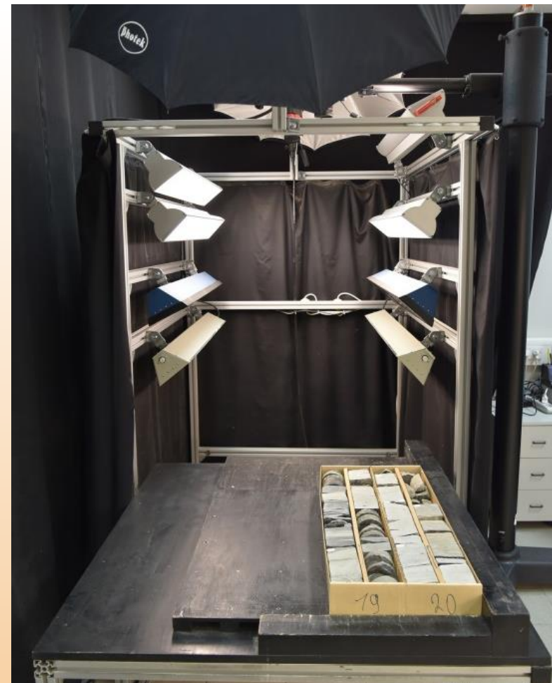
Фото полноразмерного керна в дневном и УФ свете
