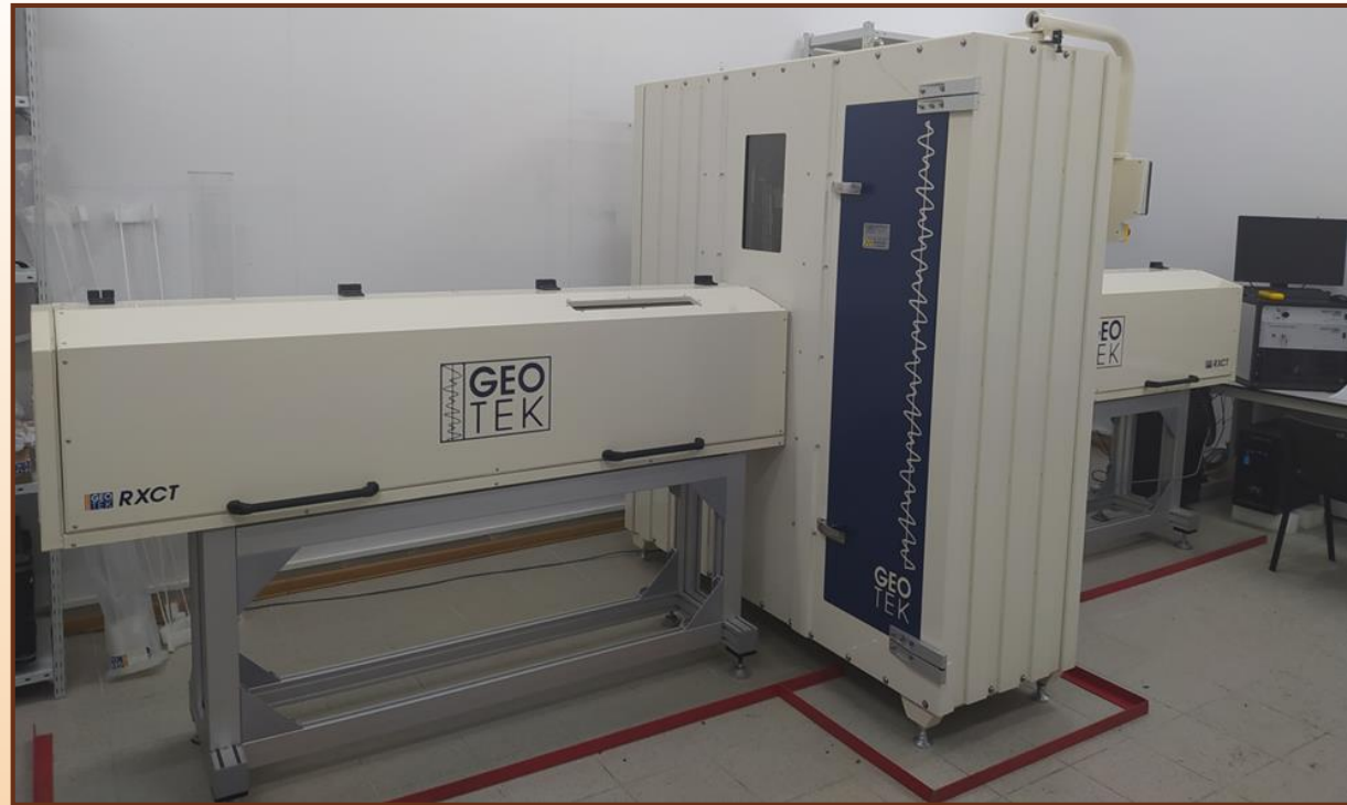
Мультисенсорный рентгеновский томограф керна RXCT (Geotek Limited, Великобритания)
