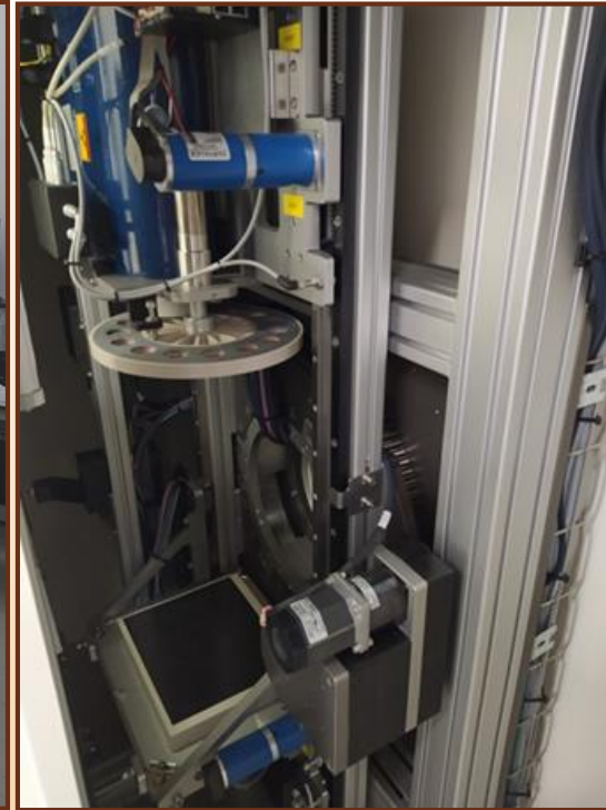
Вращающаяся система «источник-детектор»
