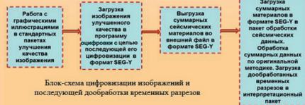
Блок-схема цифровизации изображений и последующей дообработки временных разрезов
